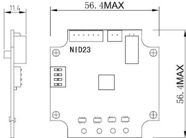
图 1. NID23 的安装尺寸图
